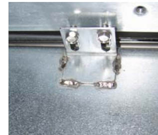
Рис. 5. Прикрепите устройство растапливания жира к направляющим с обеих сторон.
