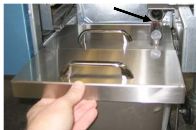
Рис. 4. Установите крышку на устройство растапливания жира и вдвиньте трубку отбора масла в разъем.
