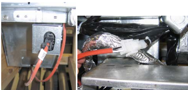
Рис. 6. Прикрепите белые двухштырьковые соединители и вставьте черный соединитель во вспомогательный блок, см. рис. *Обратите внимание: расположение черного соединителя может отличаться от показанного на фотографии.
